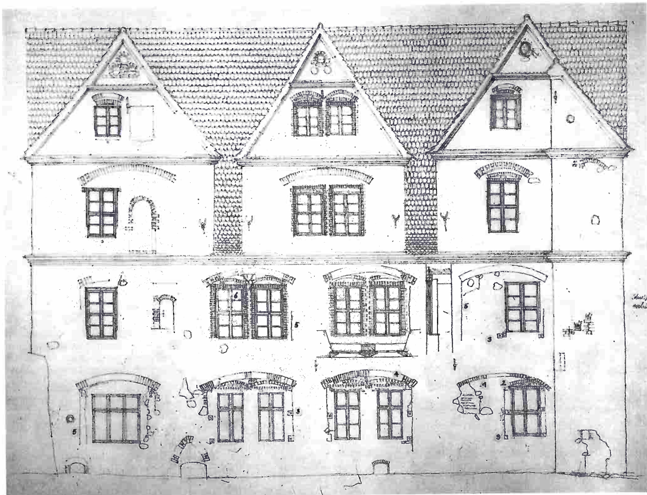
26 Demerthin, Schloss, Fassade der Südseite, Kartierung der Befunde einer Fassadenuntersuchung 1998 auf der Grundlage von photogrammetrischen Aufnahmen der Messbildstelle GmbH durch Monika Loddenkemper und Peter Goralczyk; Zeichnung von Peter Goralczyk, 1998.
